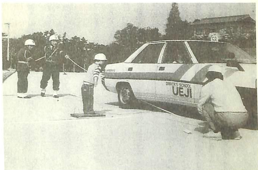
①「車は急に止まらない」車の制動距離を測る交通指導員のおじさん
